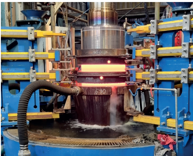
Bild 1: Zweifrequenzanlage mit gekoppelten, simultan betriebenen Induktoren für eine niedrige und eine hohe Frequenz.
